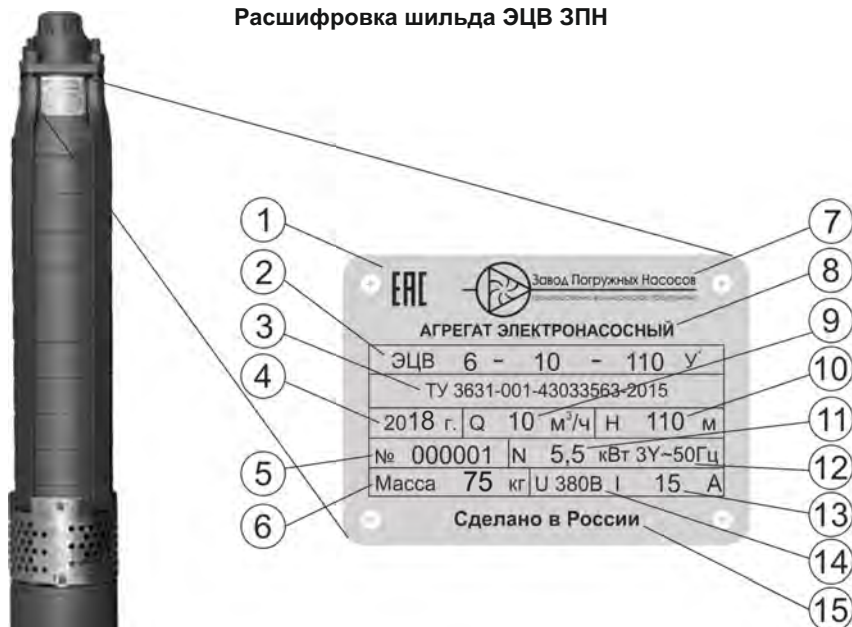
Расшифровка шильда ЭЦВ ЗПН
